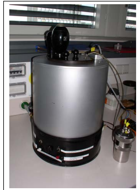
Das adiabatische Bombenkalorimeter (IKA-Werk Staufen)
