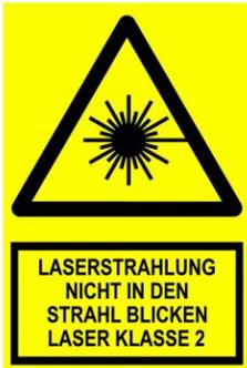
Der verwendete Laser ist ein Laser der Gefahrenklasse II, d.h. die Leistung ist potenziell ausreichend, um bei direkter Einstrahlung ins Auge zu einer Schädigung der Netzhaut zu führen!
