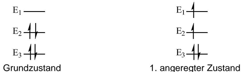
Zur Anregung vom Grundzustand in den 1. angeregten Zustand muss die Energiedifferenz zwischen den Energieniveaus  $E_2$  und  $E_3$  aufgewendet werden:
