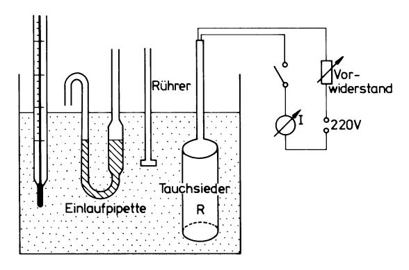
Als Kalorimetergefäß dient ein Dewar, der mit 600 g destilliertem Wasser gefüllt wird. Die Einlaufpipette wird mit 50 g destilliertem Wasser gefüllt und mit dem Tauchsieder, dem Rührer und dem Thermometer in das Dewargefäß eingesetzt.
